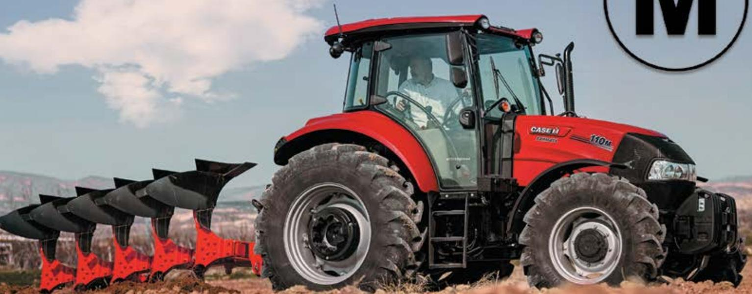
Nuevos tractores Farmall M ActiDrive4, transmisión semipower shift de 16 velocidades, capacidad de levante hidráulico de 5400 kg, sistema hidráulico de centro cerrado, caudal hidráulico de 80 l/min y control electrónico de tiro, combinan la productividad, eficiencia y comodidad que requiere el campo Mexicano.
